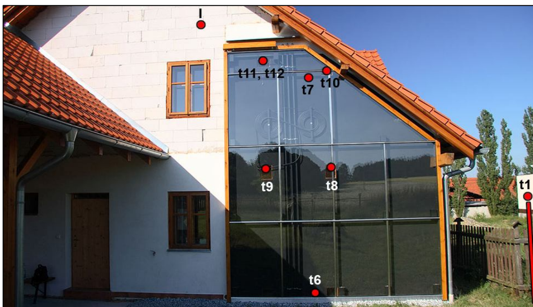
Obr. 10: Umístění čidel č. 1, 6, 7, 8, 9, 10, 11 a 12 a snímače intenzity slunečního záření I
